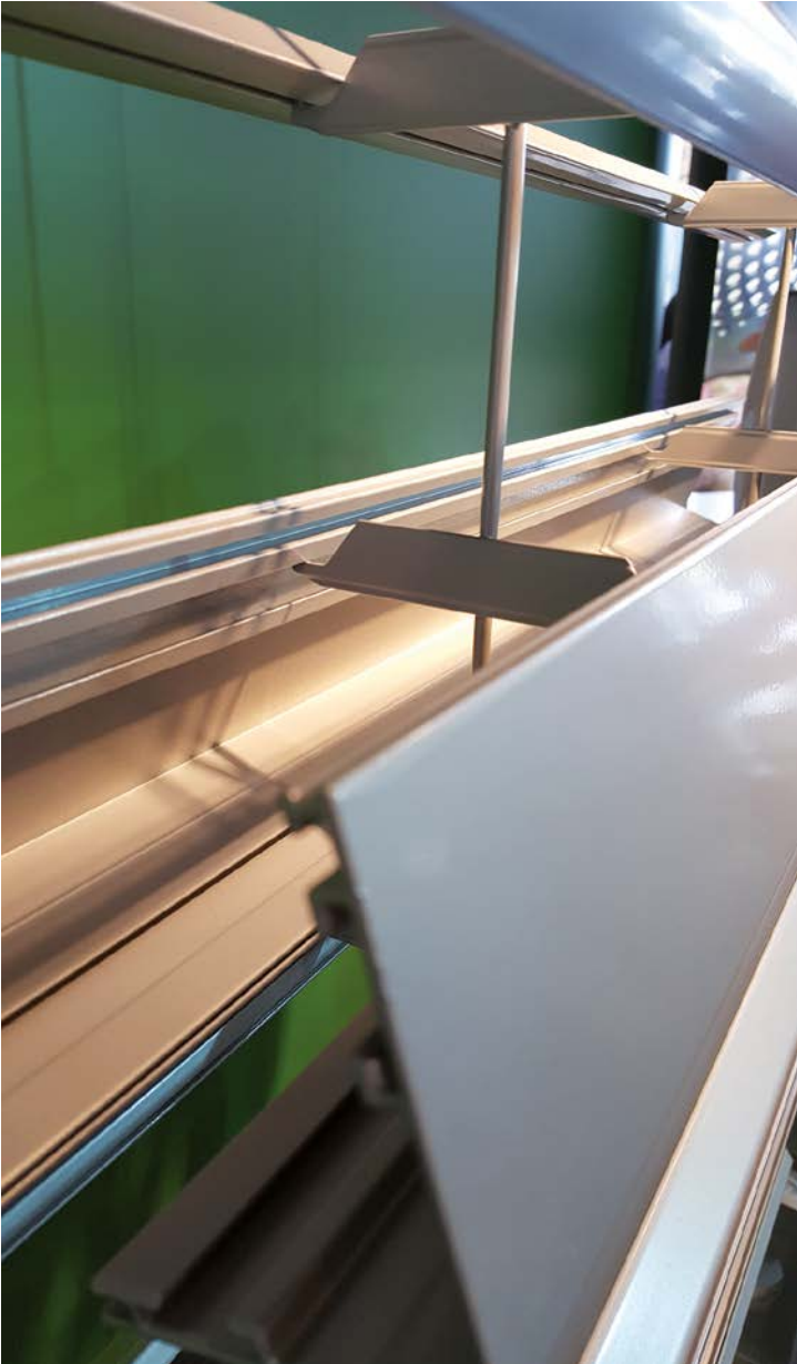
Il telaio HQS presenta lamelle metalliche per l'appensione di componenti variabili dai singoli pezzi fino ai profili.
