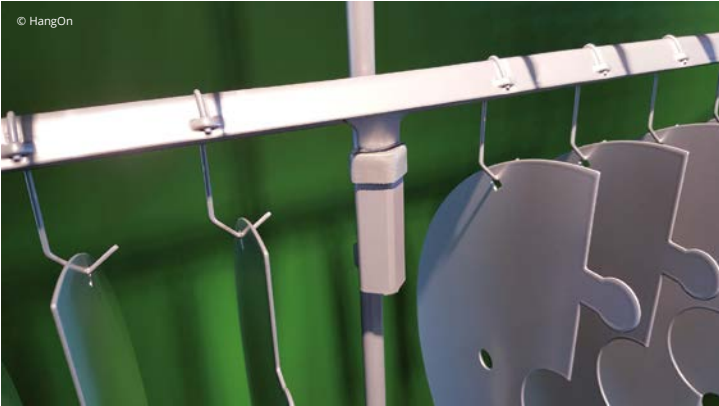
Sulla barra HQC è possibile posizionare ganci con diametro di 1,5 mm, ma solo da un lato.
